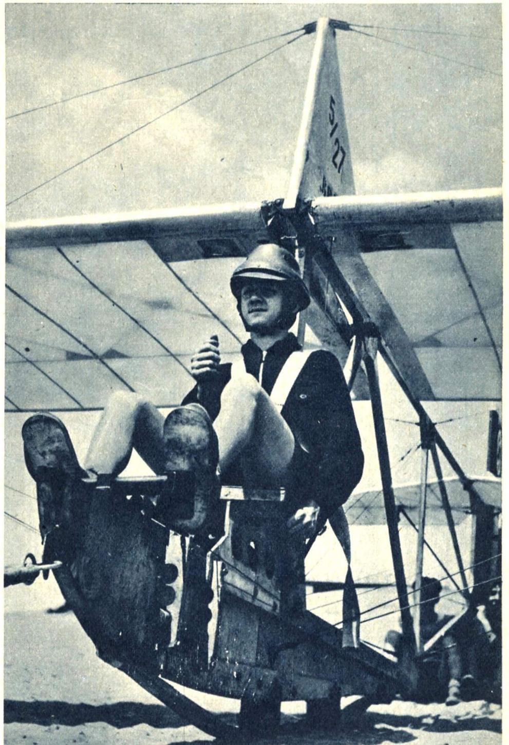
Startfertig! Das Startseil ist vorn in den Starthaken eingehängt. Noch ein Blick auf die Startmannschaft, die gleich das Seil ausziehen wird — dann wird der Gleiter davonschnellen.
