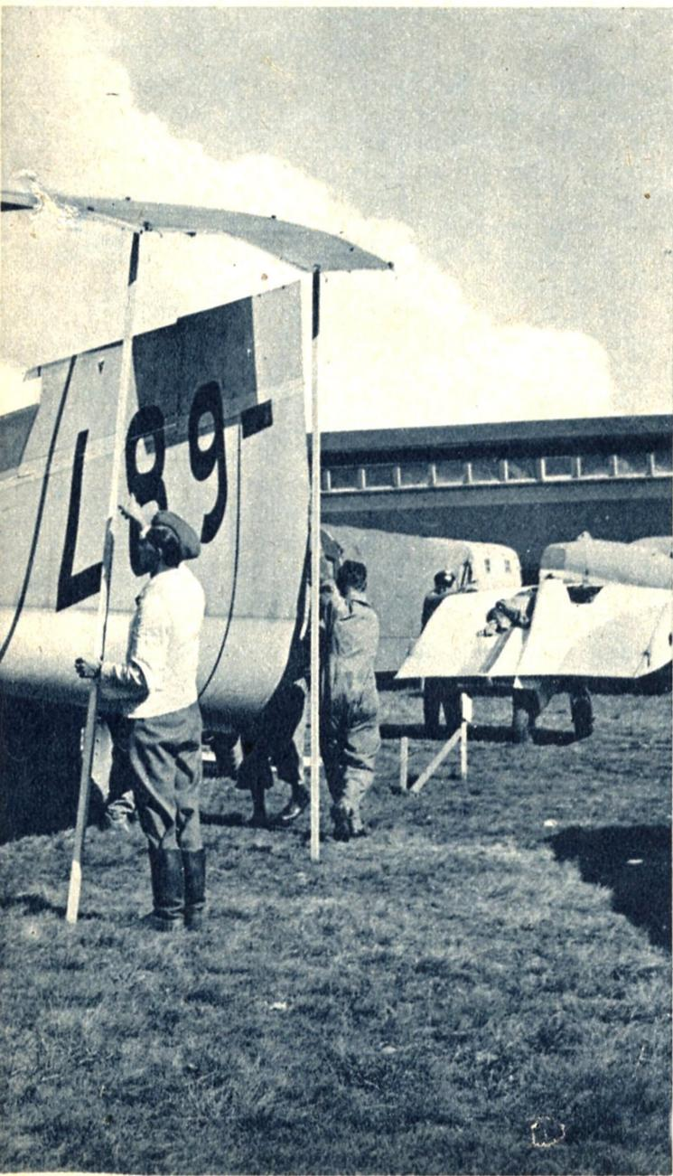
Links: Eines der an der „20. Rhön“ teilnehmenden Segelflugzeuge der Luftwaffe wird aus dem Transportwagen geholt, dessen Seitenwände hier gerade auseinandergelegt werden, um die Einzelteile der kunstgerecht verstaute Maschine herausheben zu können.
